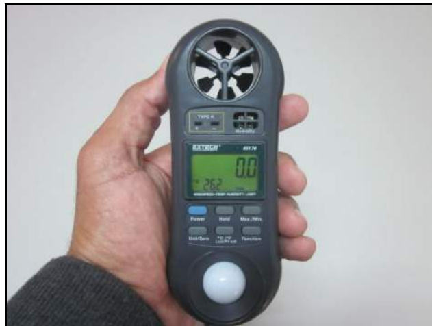
Foto 6.6.2.3-1. Estación meteorológica Extech 45170.
