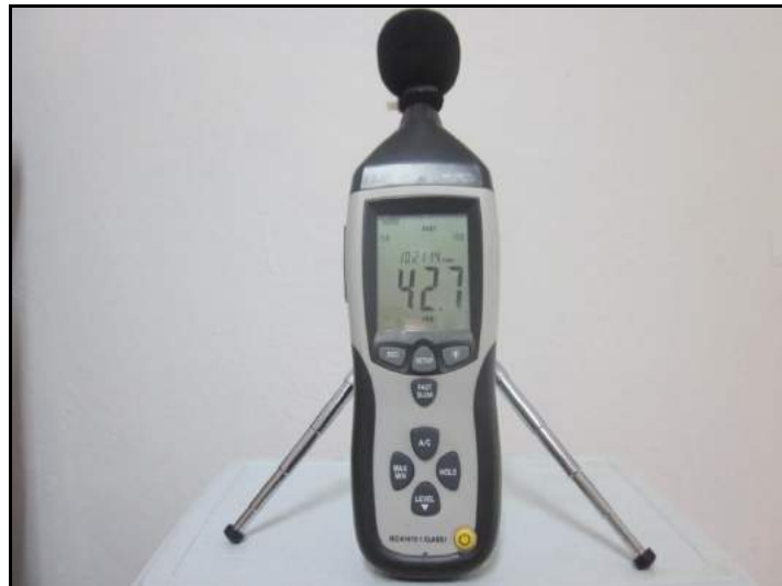
Foto 6.6.2.3-4. Sonómetro marca CEM DT-9952 (IEC-61672-1 CLASS 2).
