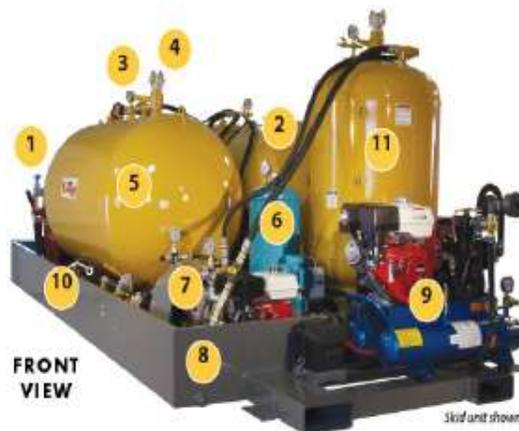
1. Manguera de doble bobina (110 metros); 2. Estanque de recepción de aceite usado; 3. Indicador de nivel de líquidos; 4. Sistema de vacío para aceite nuevo; 5. Estanque de aceite nuevo; 6. 3 Unidades de micro filtración; 7. Bomba de aceite fresco; 8. Bandeja de contención secundaria; 9. Compresor de Aire, 10. Sistema de calefacción; 11. Estanque flush (opcional)
